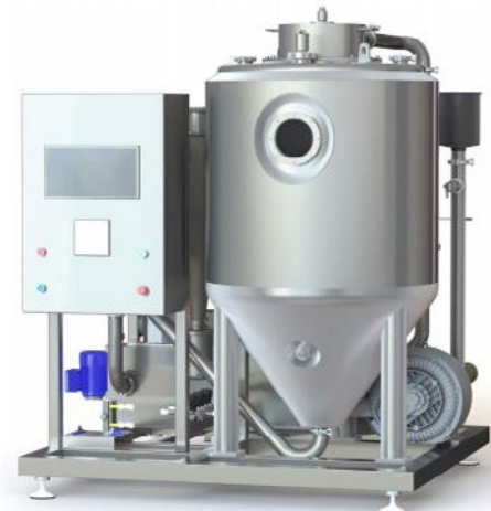
Figura 2. -Equipo de concentración a vacío y diseño de un equipo de secado por atomización
