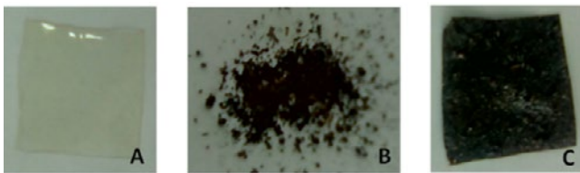
Figura 4: (A) película de quitosano, (B) orujo de aceituna, (C) película de quitosano que contiene orujo de aceituna
