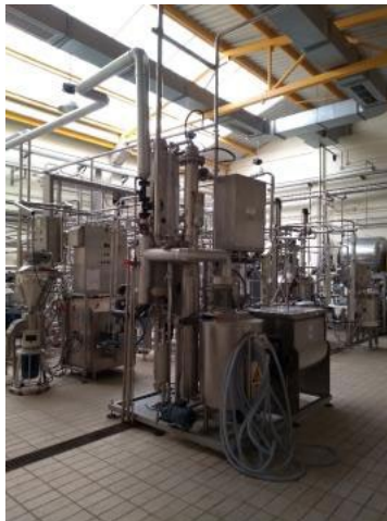
Figura 2. -Equipo de concentración a vacío y diseño de un equipo de secado por atomización
